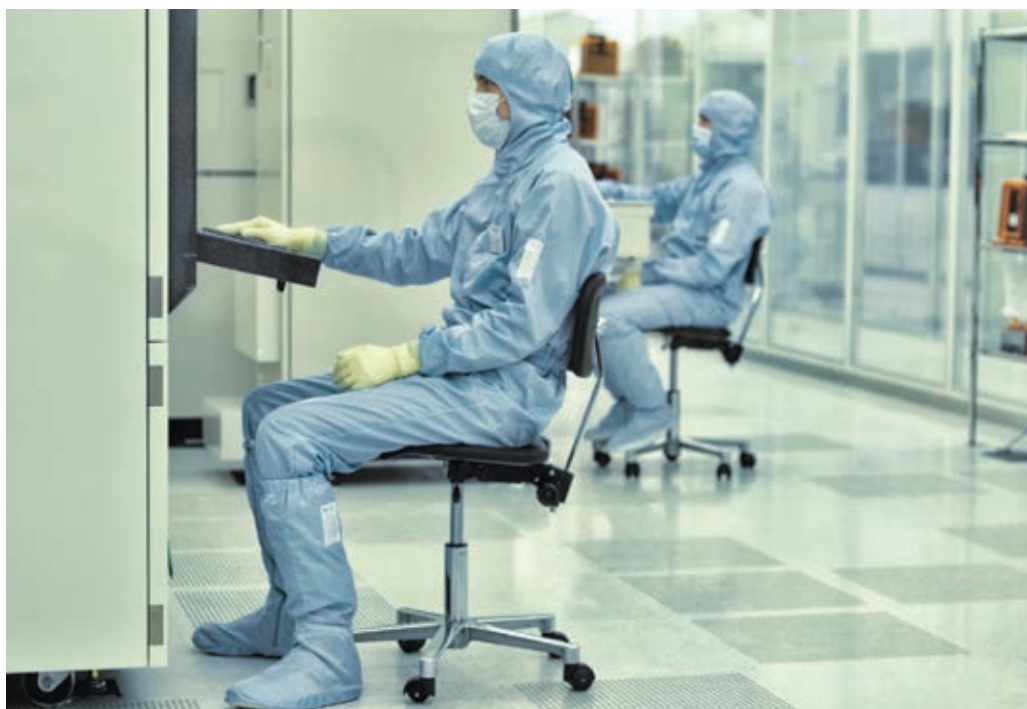
Производство интегральных схем по технологии 180-90нм в «чистой комнате» завода «Микрон». Фото: sk.ru
