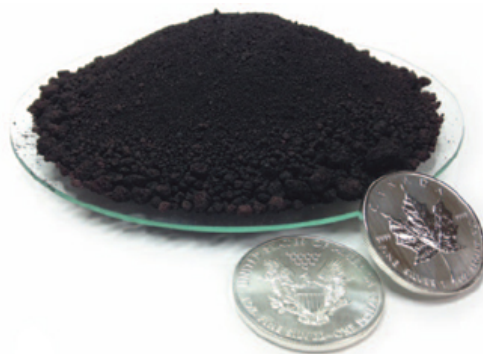
Рис. 1. На блюде диаметром 18 см – нанопорошок серебра массой 140 г.
