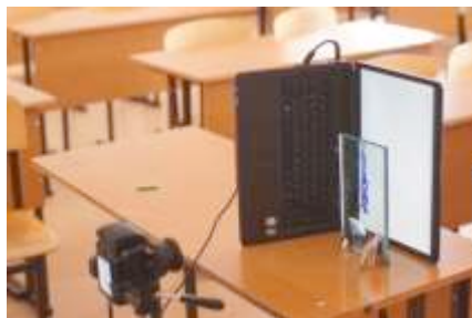
Рис.2 Экспериментальная установка: фотоаппарат, экран подсветки, ячейка Хеле-Шоу
