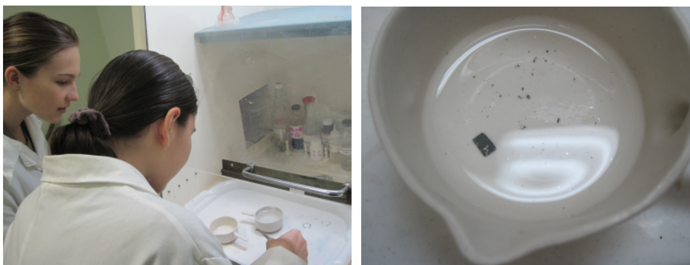
Рис. 10. Работа на химическом участке: а) погружение ; б) процесс «взрыва» ZnO со слоем Ni
