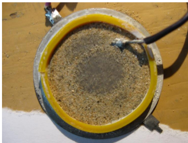
Рис. 4. Смесь микро- и нанопорошка на поверхность пьезоэлемента
