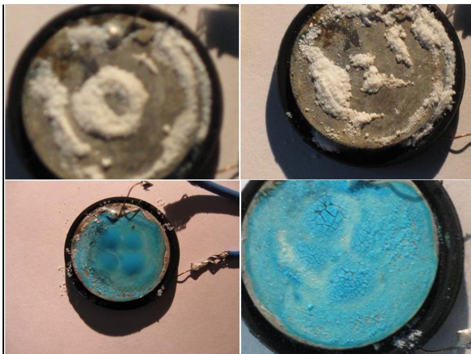
Рис. 6. Примеры фигур, полученных с нанопорошком диоксида кремния. Внизу - в подкрашенной воде. (Частота- 32 кГц)
