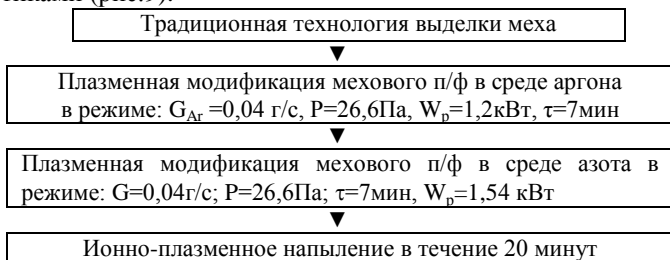
Рис. 9. Схема производства меха дорогого ассортимента с применением многократной последовательной плазмохимической обработки и нанопокровий из металлов и их соединений.
