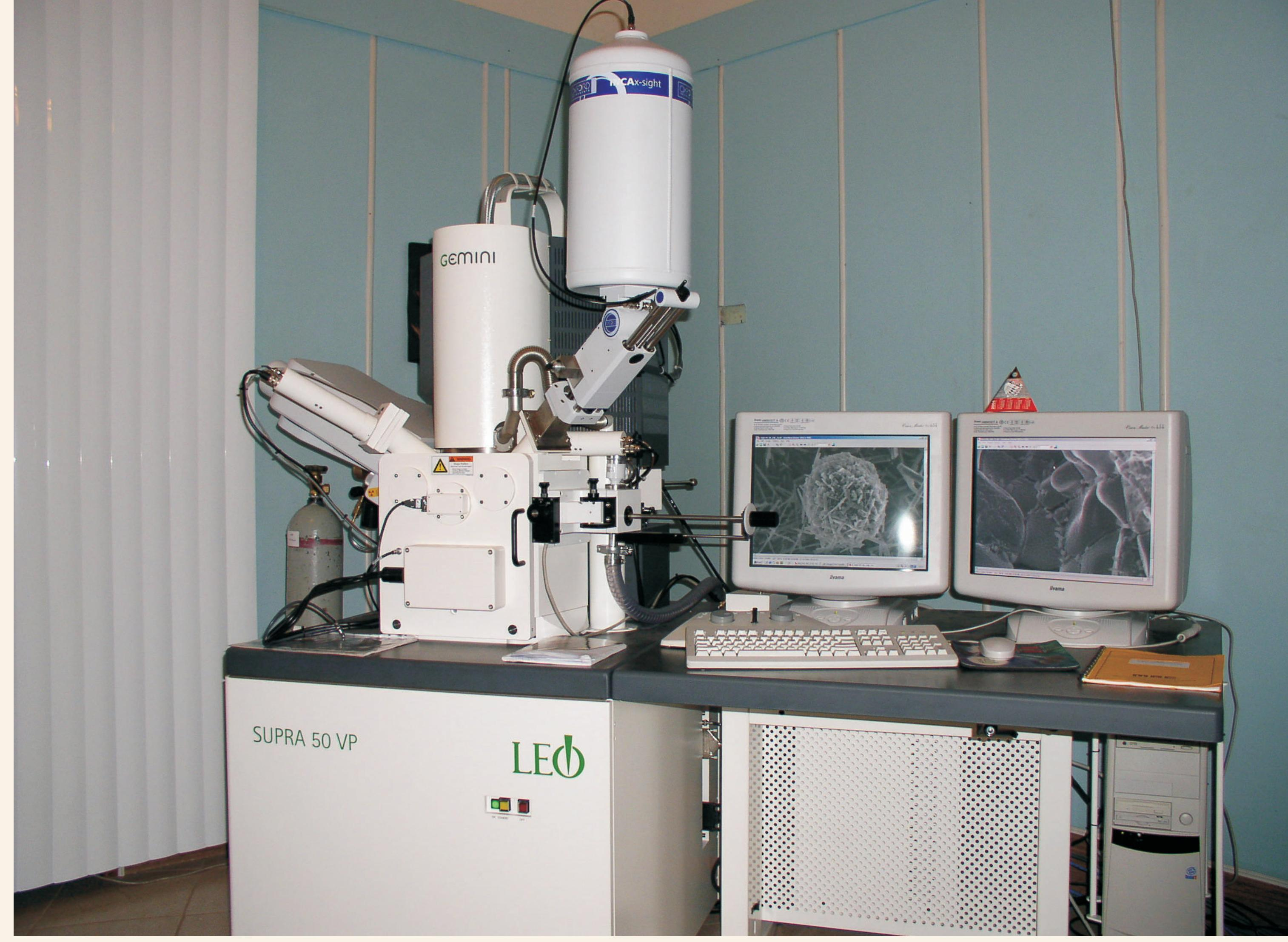
! Предназначен для изучения широкого спектра материалов в режимах высокого и низкого вакуума, оснащен комбинированной системой волнового и энергодисперсионного микроанализа INCA Energy+ (Oxford, Англия). Основные характеристики прибора:
