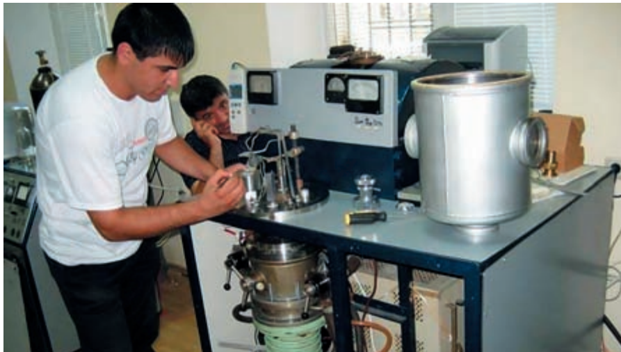
Рисунок 4. Установка для получения пленок методом магнетронного распыления
