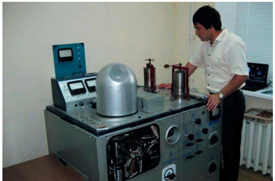
Рисунок 3. Установка для получения пленок методами газовой фазы синтеза и магнетронного распыления
