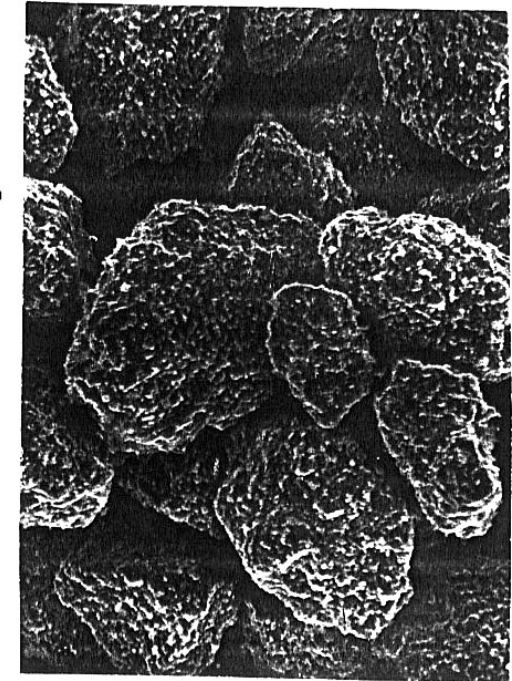
Структура агрегатов субмикронных частиц после помола: деагрегация + активация = агрегация
