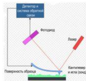
Рис. 1. Схема работы сканирующего атомно-силового микроскопа.
