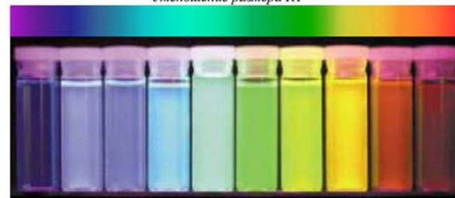
Изменение цвета (полосы испускания) коллоидного раствора частиц CdSe в оболочке ZnSe в зависимости от размера квантовых точек.
