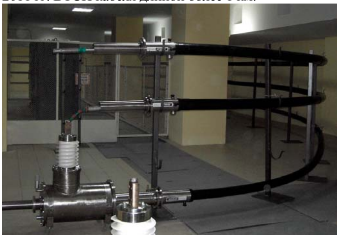
Рис. 2. Первый российский силовой ВТСП кабель длиной 30 м, созданный в ОАО "ВНИИКТ" на полигоне ОАО «НТЦ электроэнергетики».
